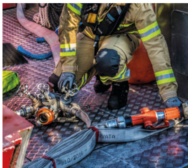
Letkupatonki toimii hyvin myös venekäytössä. Ahtaassa tilassa veneen kannelle työvara purkautuu siististi.
