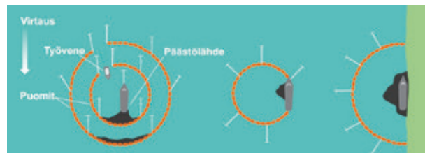
Rajoituspuomituksella estetään öljyn leviäminen päästölähteen luota. (SökoSaimaa 09B)
