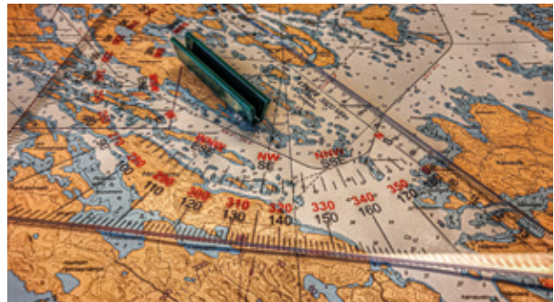
Astelevy siirretään apuviivaimen avulla kartan leveyspiiriviivan päälle siten, että astelevyn keksipiste on leveyspiiriviivan päällä. Kulkusuunnat luetaan kehältä. Tässä kuvassa suunta luoteeseen kuljettaessa on 323 astetta ja kaakkoon kuljettaessa 143 astetta.
