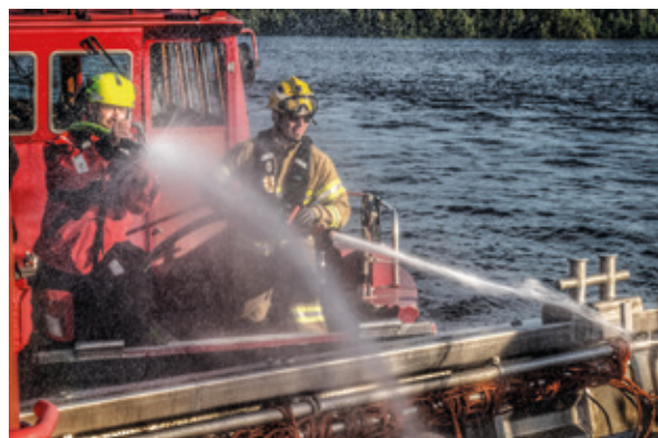
Perusselvitys tehtynä pelastusaluksen kannelle. Sumusuihkulla suojataan omaa alusta lämpösäteilyltä.
