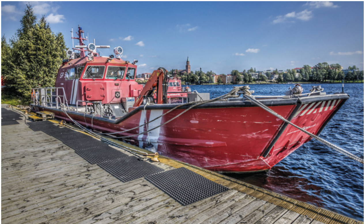
Alus on kiinnitetty keula- ja peräköysillä sekä keula- ja peräsprungeilla.
