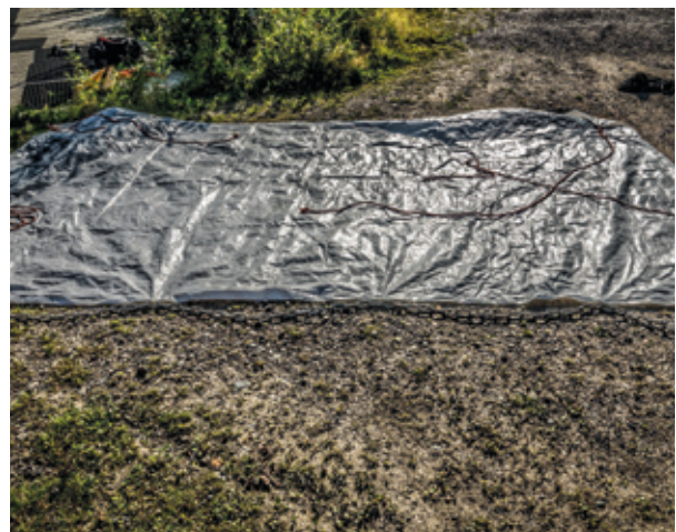
Vuotomaton etureunaan kiinnitetään ketju tai muu paino, joka helpottaa maton vetämistä rungon alle.
