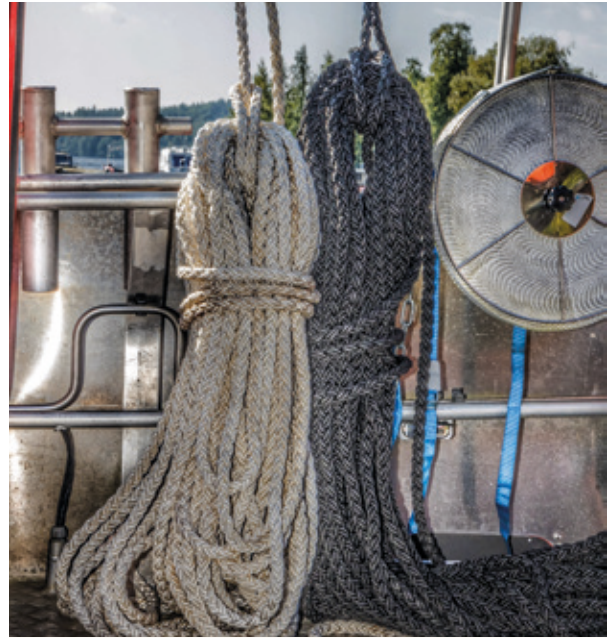
Köydet säilytetään koillattuna kaiteesta roikkumassa, kaapissa tai kelalla. Kuvassa valkoinen hinausköysi, musta ankkuriköysi ja valkoinen ankkuriliina
