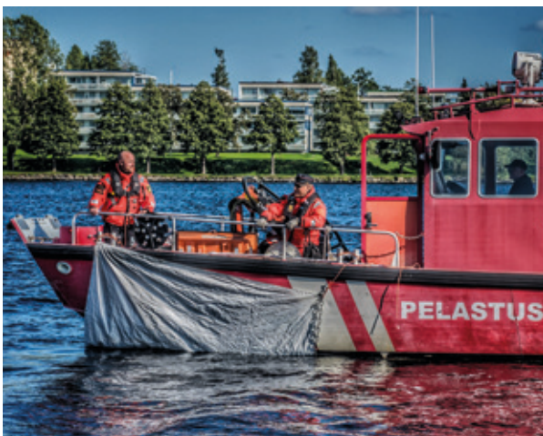
Vuoto voidaan tukkia aluksen ulkopuolelta vuotomatolla.
