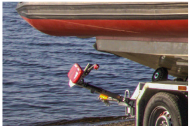
Valot nostettu ylös, jotta sähköosat eivät saa kosteutta.
