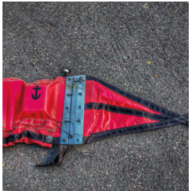
Puomia hinataan aina vetopäästä. Vaikka vetopää on suunniteltu hinaukseen, voi se hajota liian suuresta rasituksesta. Puomin ylälaidassa on kädensijat helpottamassa puomin käsittelyä.
