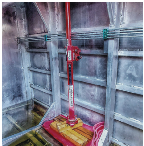
Vuodon tukkiminen työntötangon avulla. Samaan käyttötarkoitukseen voidaan käyttää myös tankolevitintä.
